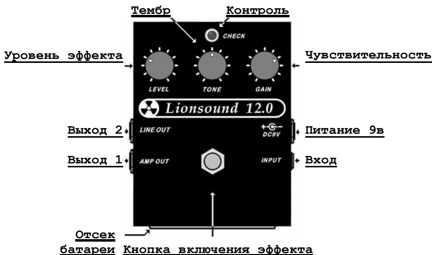
Рис 4. Расположение разъемов и органов управления на корпусе Lionsound 12.0.
