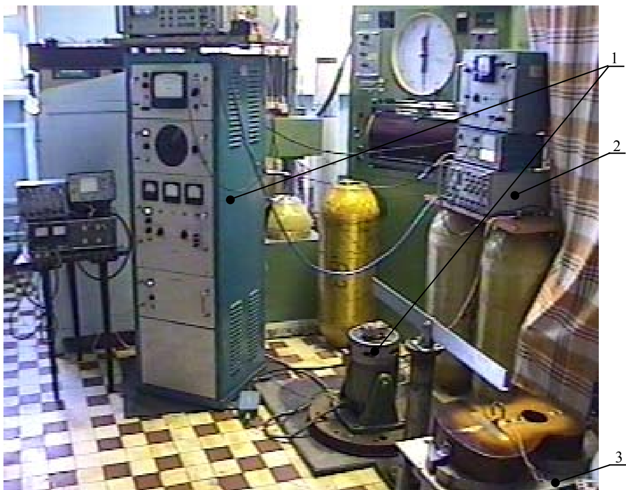
Рис.4.1. Общий вид экспериментальной установки (1 – вибростенд; 2 – тензометрический усилитель; 3 – стол испытательный)
