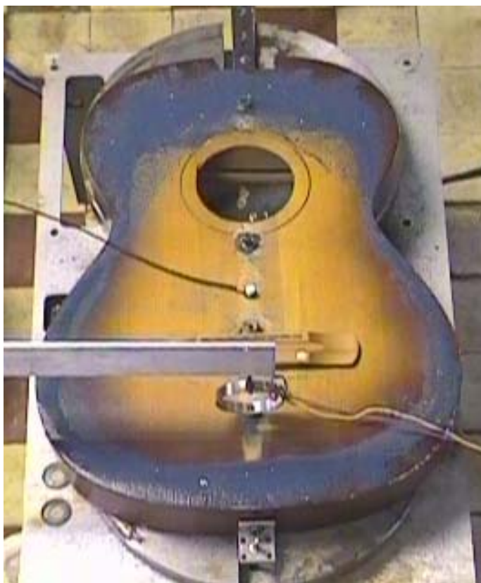
Рис.4.5. Первая форма колебаний деки без подкреплений
