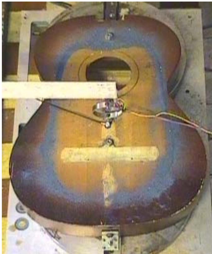
Рис.4.5. Первая форма колебаний деки без подкреплений
