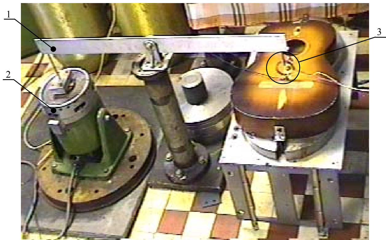
Рис.4.3. Система возбуждения колебаний (1– траверса; 2 – вибратор; 3 – тензометрический динамометр)
