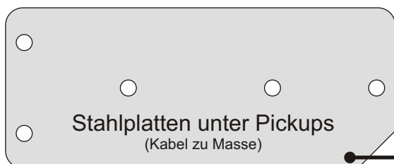
Saitenerdung (Kabel zum Steg)
