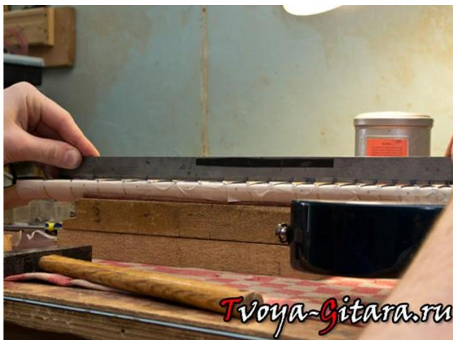
Как часто показывает практика, разные положения анкерного стержня позволяют производить регулировку грифа в зависимости от изменения погодных условий, износа ладов и т.п., а также экспериментировать с натяжением при разной толщине струн.
