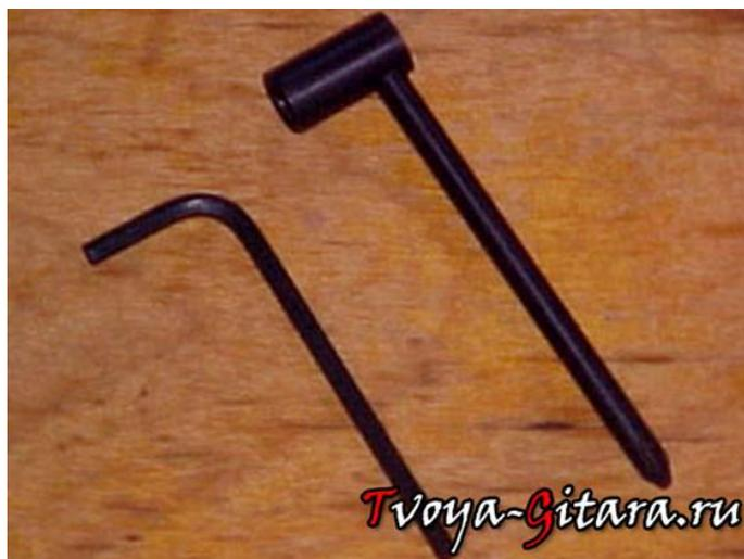
Для регулировки анкера вам понадобится один из наиболее распространенных типов ключей. На изображении показаны: слева – ключ Аллена (шестигранник), справа – бочкообразный ключ. Наиболее распространены гайки под внутренний шестигранник 4-5 мм, но для американских Fender Strat вам понадобится специальный ключ 3,175 мм (1/8”), но такие ключи у нас, к сожалению дефицит.
