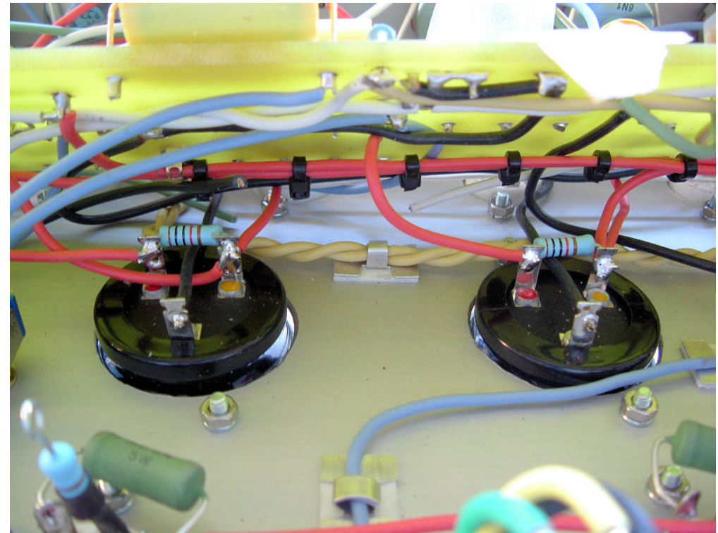
Verdrahtung der beiden Becher-Elkos
