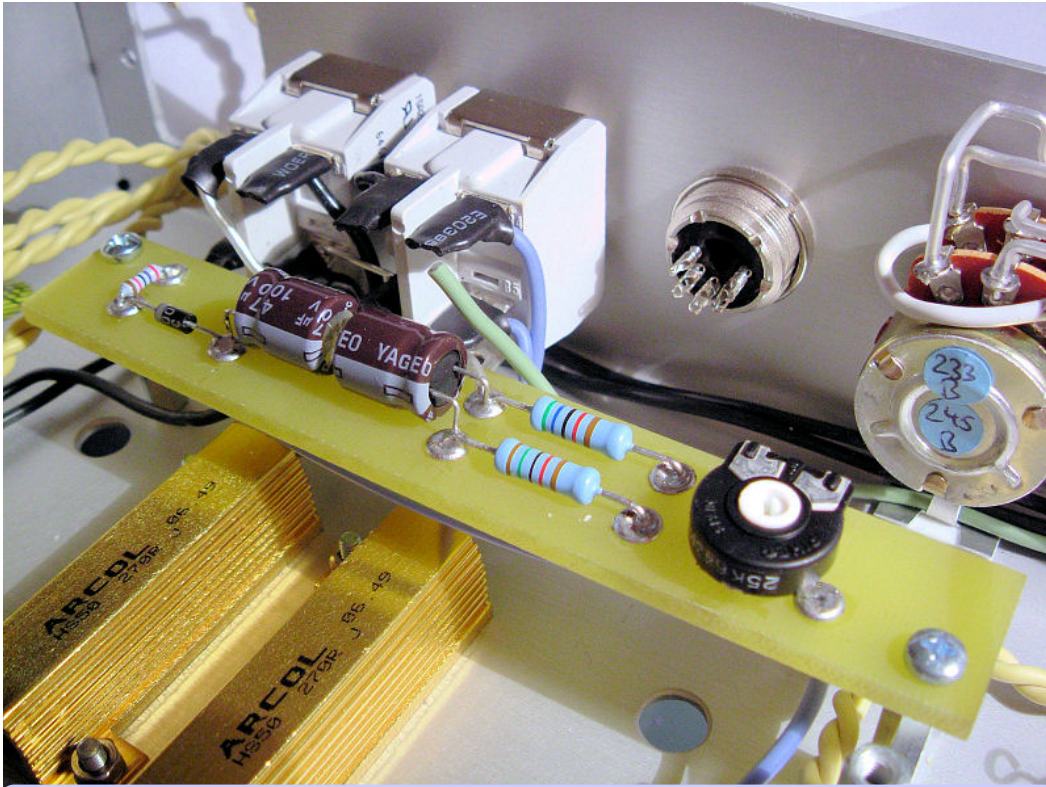
Beim Aufbau habe ich die Kabel entsprechend lang gelassen, so dass diese nach dem Einsetzen des Boards nun gekürzt werden müssen. Dabei sollten sie aber noch so lange gelassen werden, dass ein sauberes Verlegen möglich ist. Das grüne nicht angelötete Kabel ist vom Booster-Board (kommt im nächsten Beitrag) und ist für die Relaissteuerung. Dieses Kabel wird später an die Switches-Buchse angelötet.
