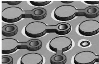
Рисунок 44 а – Фрезерование в плате сквозных отверстий и установка тефлоновой трубки
