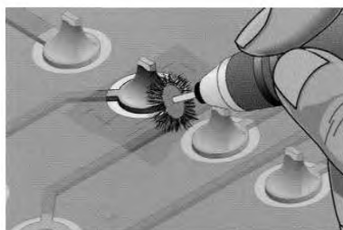
Рисунок 4 с – Мягкое покрытие удаляют вращающимися щетками
