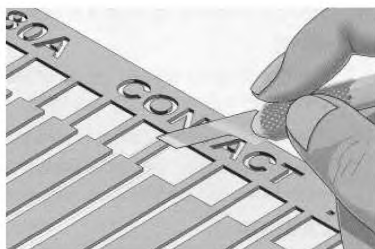
Рисунок 35 с – Вырезание нового концевого контакта
