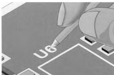
Рисунок 7 с – Нанесение маркировки палочкой, смоченной эпоксидным составом
