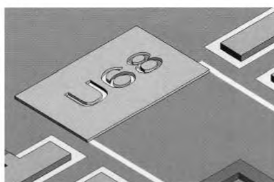
Рисунок 7 б – Нанесение маркировки через трафарет
