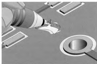
Рисунок 10 а – Удаление поврежденного материала фрезой
