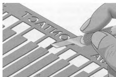
Рисунок 35 б – Удаление клеящей пленки с участка под паяное соединение
