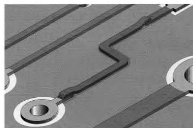
Рисунок 19 ф – Покрытие проводника эпоксидным составом
