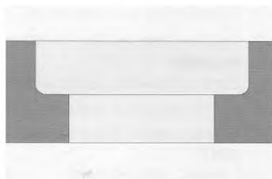
Рисунок 10 с – Создание уступа в кромке печатной платы
