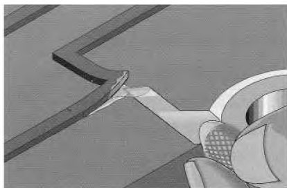
Рисунок 17 а – Нанесение эпоксидного состава под отслоившийся проводник
