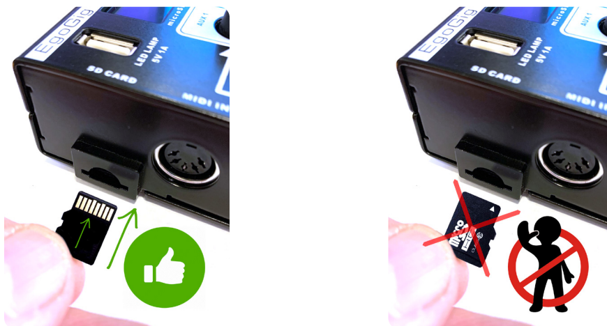
Рис. 1.4 — Пример правильной (слева - «контактами вверх») и неверной (справа — «контактами вниз») ориентации карты памяти micro SD в пространстве относительно прибора AMT EgoGig EG-4
