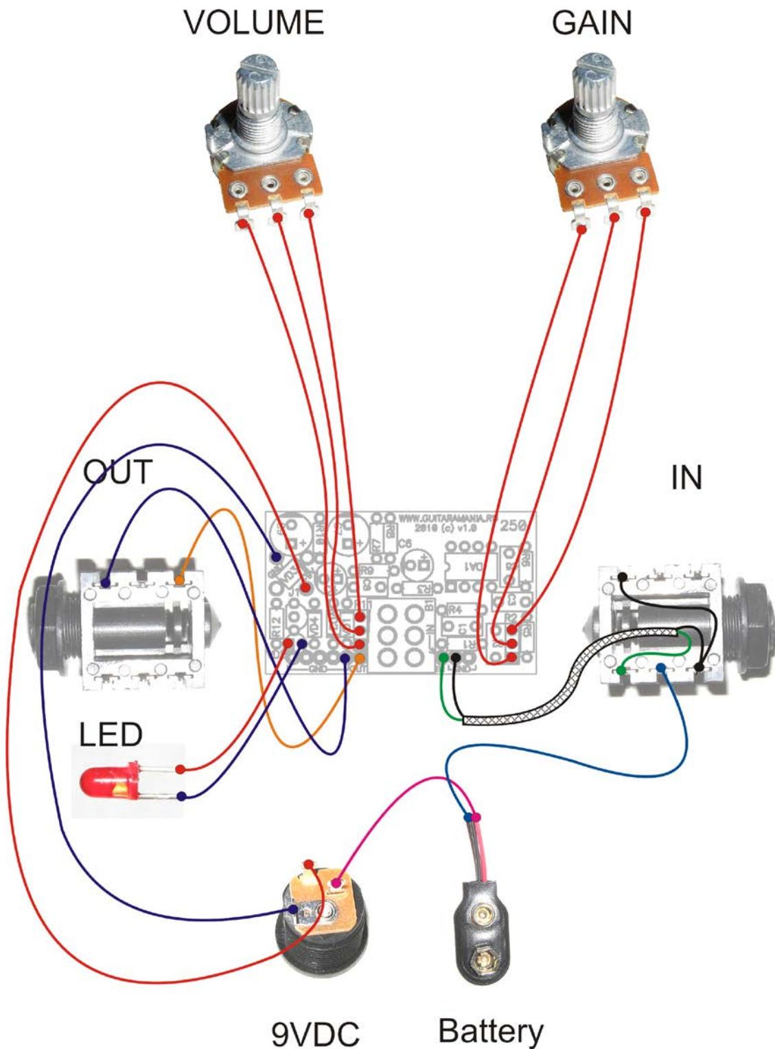
Для коммутации входного гнезда используется экранированный провод МСЭО16-13, средняя жила которого соединяет паячную точку IN платы и сигнальный вывод гнезда, а оплётка аккуратно скручивается в жгут и запаивается на точку GND и на земляную kleemу гнезда. Для остальных соединений используется провод МГШВ.
