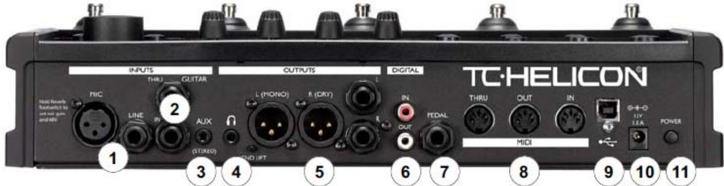
1. **MIC и LINE входы** – микрофонный и линейный входы. Подключите микрофон или аудиоустройство к соответствующему входу. Одновременно может быть подключено только одно устройство. Удерживайте педаль REVERB для автоматической настройки усиления при переходе с микрофонного входа на линейный и обратно.
