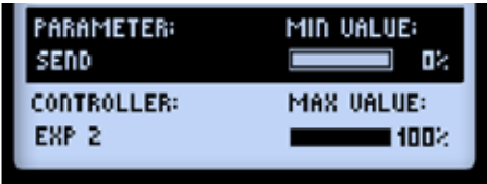
Опции окна "Controller Assign" для петли эффектов
