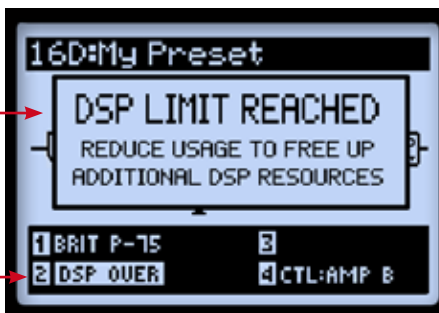
Экран "Маршрут сигнала" - отображение предупреждения о достигнутом лимите DSP
