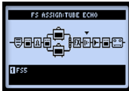
Экран "Footswitch Assign" с выбранной моделью эффекта Delay
