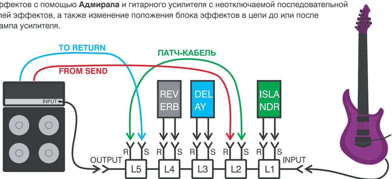
Если разбить стандартный гитарный усилитель **AMP** на 2 блока - преамп **PREAMP**(предусилитель - от инпута до сенда) и мощник **PWRAMP**(усилитель мощности - от ретерна до кабинета), то можно получить например такие цепи сигнала:
