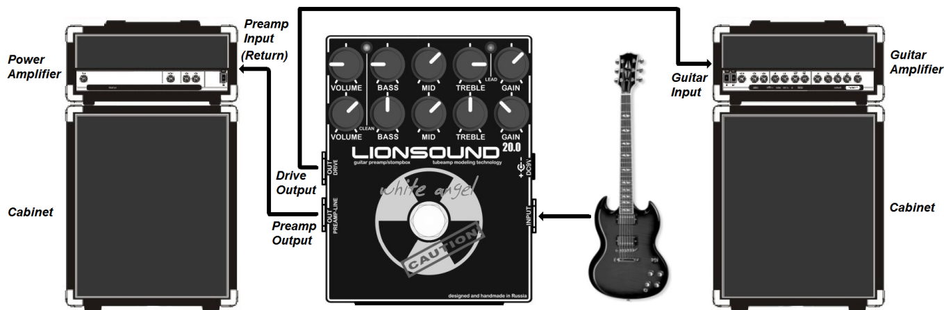
Рис.1. Варианты подключения Lionsound 20.0
