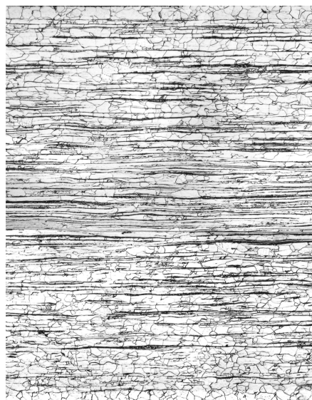
Рис. 1. Структура горячекатаной электротехнической анизотропной стали, \times 50
