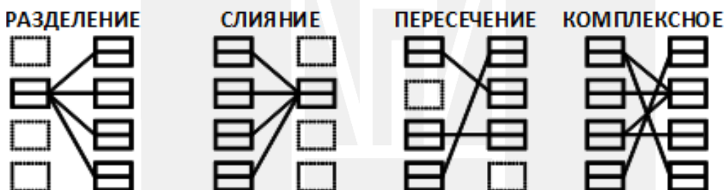
Рисунок 4-5 Кабели могут ПЕРЕСЕКАТЬСЯ друг с другом без взаимовлияния. Маршрутизация при необходимости, может быть также КОМПЛЕКСНОЙ.
