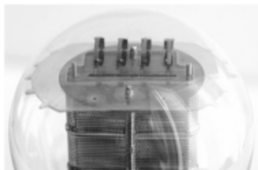
Рис. 2.41 Напряжение W-образной нити прямонакального вольфрамового катода, имеющего покрытие из тория, с использованием пластинчатых пружин
