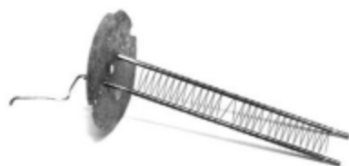
Рис. 2.46 Управляющая сетка пентода типа 6K7, имеющего переменный коэффициент усиления. Необходимо отметить, что значительное отклонение шага намотки сетки от равномерного наблюдается в центре и на расстоянии, расположенном примерно на одной четвертой от каждого конца держателей
