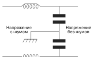
Рис. 6.34 Фильтрация синфазного шума в накальной цепи
