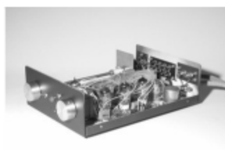
Рис. 8.29 Авторский прототип предусилителя (внутренний вид)
