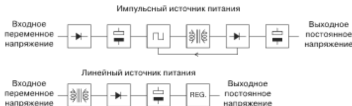
Рис. 6.1 Сравнение блок-схем линейного и импульсного источников питания
