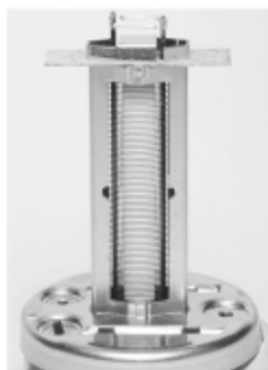
Рис. 2.47 Пластины, формирующие поток электронов, и конструкция катод-сетка СВЧ двойного лучевого тетрода типа QGV07-50
