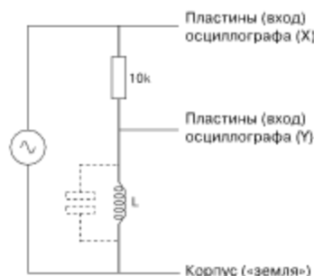
Рис. 5.13 Использование фигур Лиссажу для определения частоты собственного резонанса катушки индуктивности
