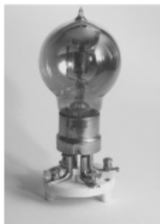
Рис. 2.1 Лампа R-типа, видны следы потемнения на колбе. (Выправленная надпись утверждает, что эта лампа является «Типом, одобренным главным почтмейстером Би-би-си»)
