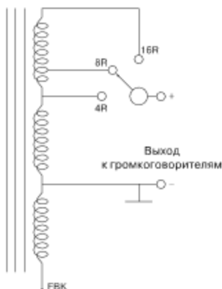
Рис. 5.18 Схема использования вторичной обмотки выходного трансформатора в усилителях Leak
