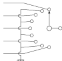
Рис. 8.12 Снижение перекрестных помех входного переключателя заземлением промежуточных контактов
