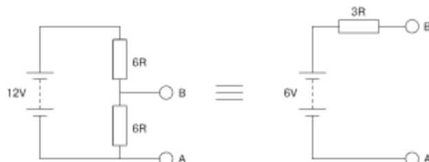
Рис. 1.10 Схема «черного ящика» и его эквивалентная схема с источником напряжения
