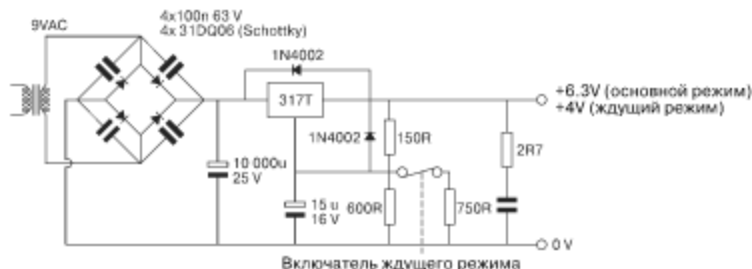
Рис. 6.43 Используемая на практике схема стабилизированного источника питания цепей накала с напряжением 6,3 В
