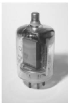
Рис. 2.50 Графитовые анодные пластины тетрода 6V08-100
