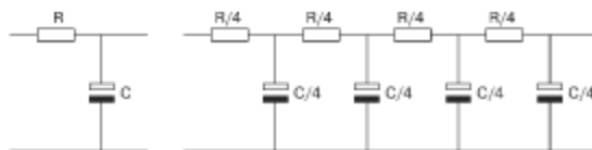
Рис. 6.23 Секционирование RC-фильтра оставляет общее значение емкости и сопротивления неизменным, но увеличивает окончательный коэффициент ослабления со значения 6 дБ/октаву до 24 дБ/октаву
