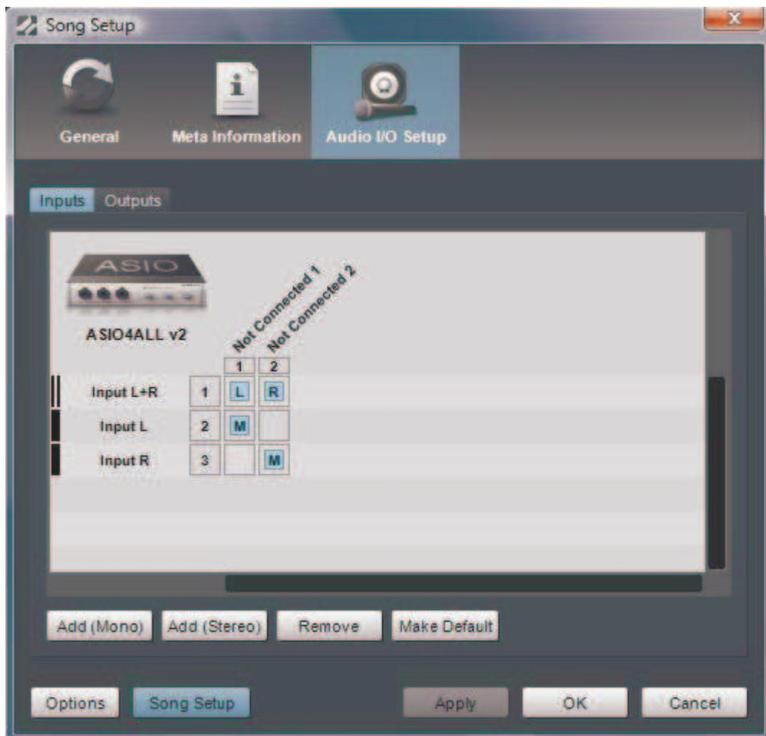
Это работает так: смотрим пересечение столбцов (железные каналы) и строк (виртуальные). Там где стоит синий квадрат, значит данный железный и виртуальный каналы задействованы.
