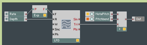
Рис. 1.4. Структура макроса LFO
